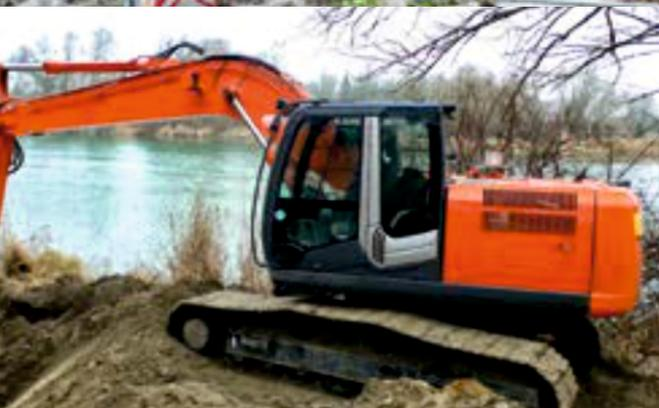
Ofrecemos una amplia gama de cadenas desde 101 mm a 260 mm de distancia de paso para adaptarse a todo tipo de excavadoras y equipos con cadenas. Todas las cadenas DuraTrack contienen grasa y están selladas para extender su vida útil. Los retenes de poliuretano aseguran un funcionamiento silencioso e impiden que los materiales abrasivos se introduzcan en las clavijas y cojinetes reduciendo así el desgaste.
